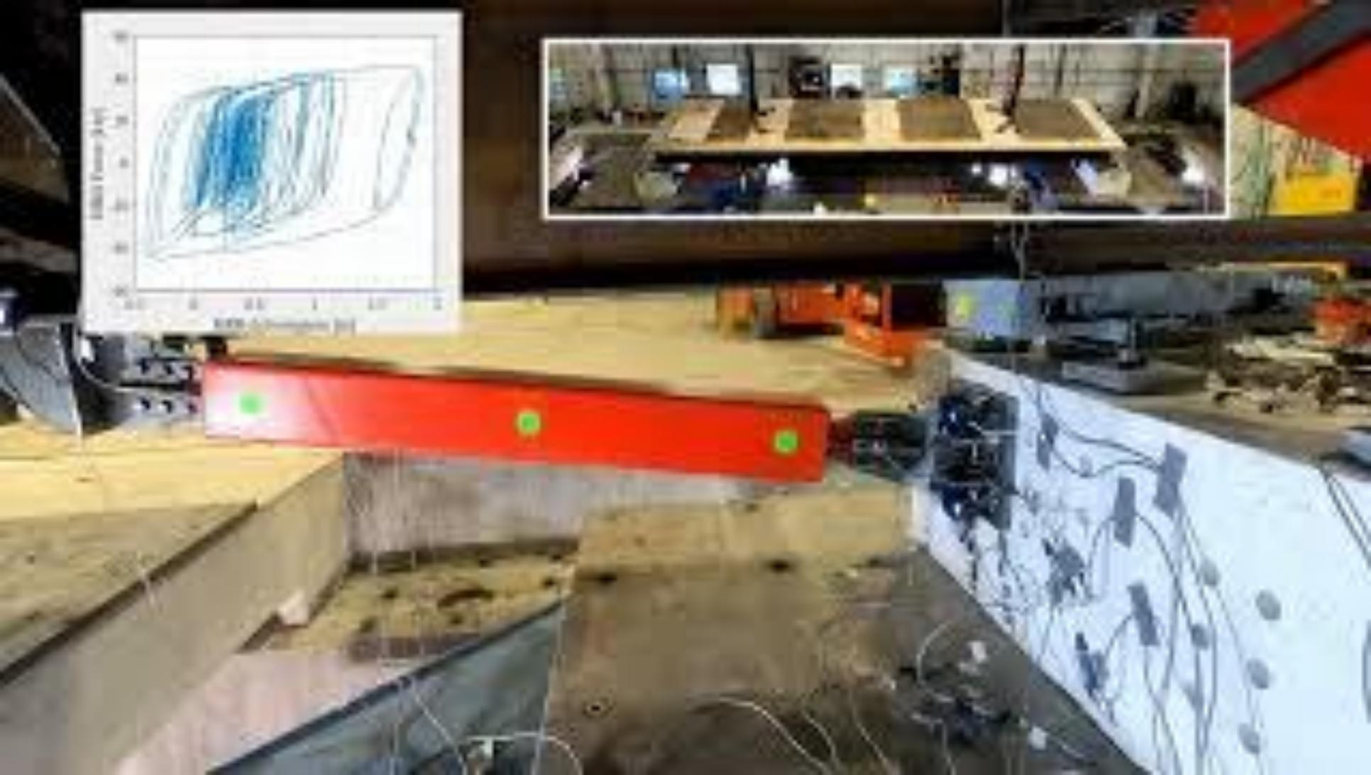
ARRIOSTRAMIENTO CON PANDEO RESTRINGIDO, QUE PERMITE REDUCIR LAS SECCIONES DE ELEMENTOS DIAGONALES DE MARCOS ARRIOSTRADOS EVITANDO EL PANDEO GLOBAL EN EL ELEMENTO Y DISIPA ENERGÍA Y USO
