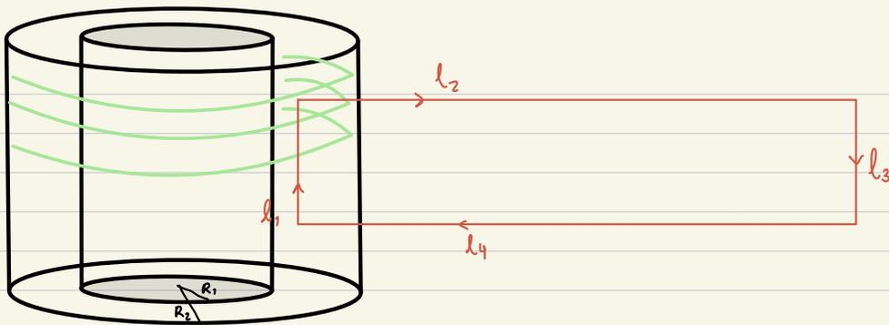
· Imponemos  $l_3$  muy lejano de la bobina  $\Rightarrow \int_{l_3} \vec{B} \cdot d\vec{l} = 0$  ( $B$  despreciable)
