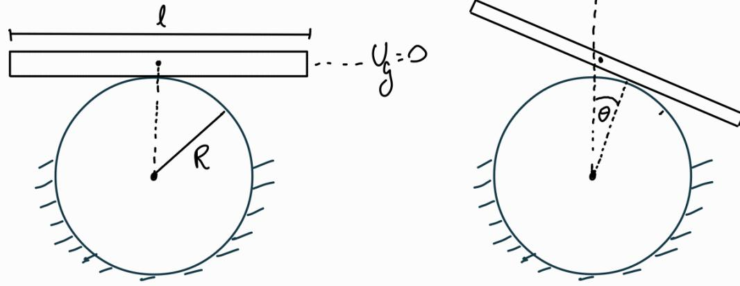
Para sacar la energía basta con describir las posiciones y velocidades del C.M. con respecto a las variables importantes del problema, en este caso  $\theta$  ya que representa bien la condición del cilindro y la perturbación. Veamos la geometría desde el centro del cilindro:
