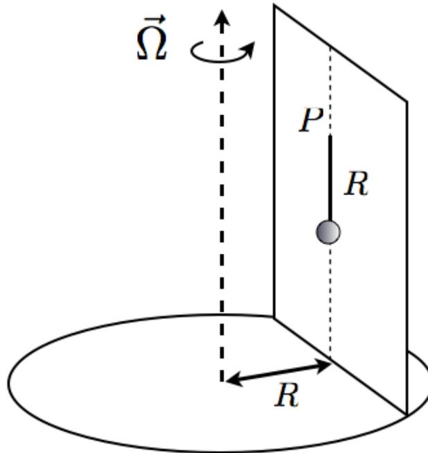
$$m\vec{a}' = \vec{F} - m\ddot{\vec{R}} - m\vec{\Omega} \times (\vec{\Omega} \times \vec{r}') - 2m\vec{\Omega} \times \vec{v}' - m\dot{\vec{\Omega}} \times \vec{r}'$$
