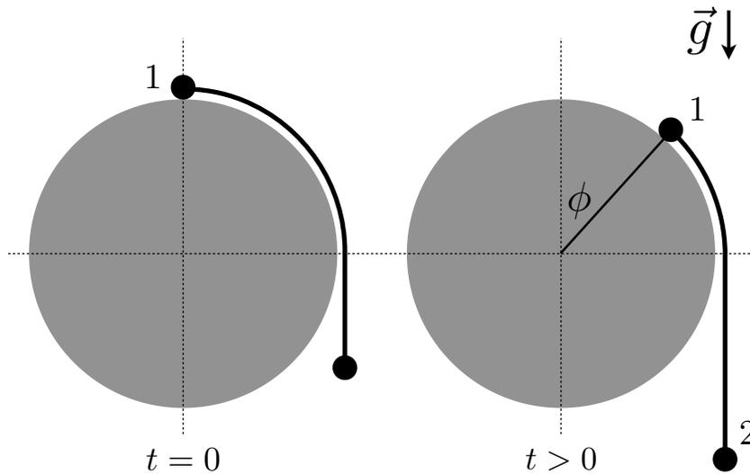
**Solución P1:** Se nos dice que  $\dot{\rho} = -v$  donde  $v = \|\vec{v}\|$ . Sigue que  $\rho = r_0 - vt$ . Luego, junto con  $\ddot{z} = 0$  y  $\dot{\phi} = \omega$ , la aceleración es  $\vec{a} = -(r_0 - vt)\omega^2\hat{\rho} - 2v\omega\hat{\phi}$ . Las fuerza total sobre  $P$  es  $\vec{F} = -mg\hat{k} - T\hat{\rho} + N_\phi\hat{\phi} + N_z\hat{k}$ . Luego, la segunda ley de newton adquiere la forma:
