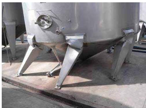
Figura 19. Pandeo de pata: (a) pata perimetral y (b) pata central.
