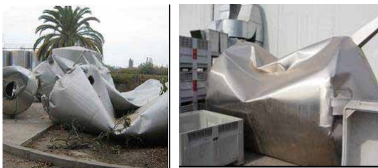
Figura 22. Colapso por vaciado rápido.
