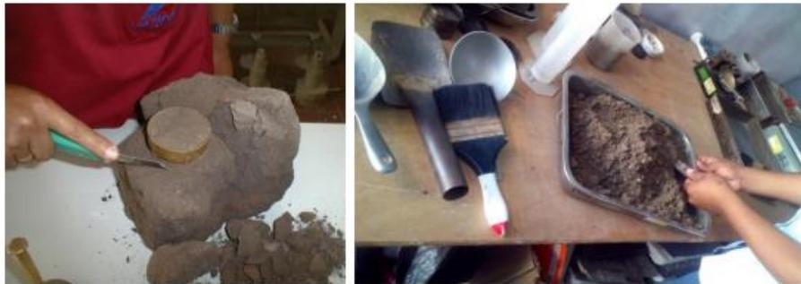
Figura 3: Tallado de probeta (izq.) y material de molde (der.)
