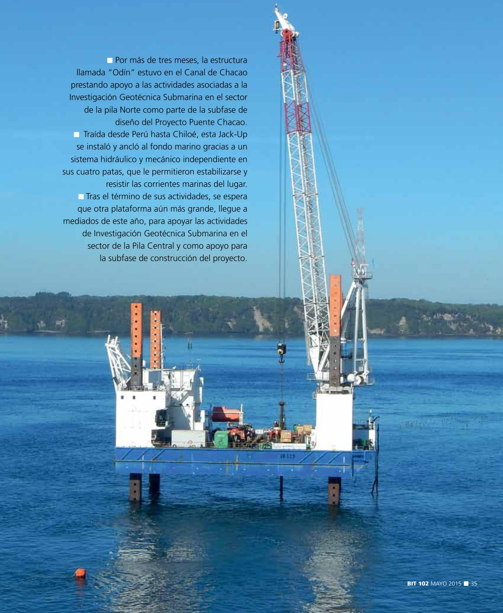
La plataforma tenía un sistema hidráulico y mecánico independiente en sus cuatro patas, que le permitía estabilizarse en el suelo marino. Su función era realizar sondajes a través del hincado de un tubo guía de hasta 34 metros, con la ayuda de la grúa de 300 toneladas más un martillo vibratorio.
