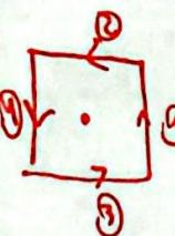
$$F = \int I d\vec{l} \times \vec{B} = \int_{①} i_1 d\vec{l} \times \vec{B} + \int_{②} i_1 d\vec{l} \times \vec{B} + \int_{③} i_2 d\vec{l} \times \vec{B} + \int_{④} i_2 d\vec{l} \times \vec{B}$$
