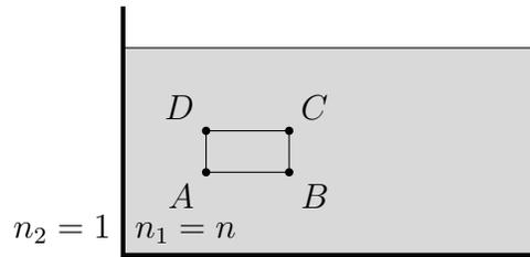
Tamaño aparente vertical  $b'$ . No cambia la altura porque en una interfase plana la magnificación vertical es 1. Directamente,  $b' = b$ .
