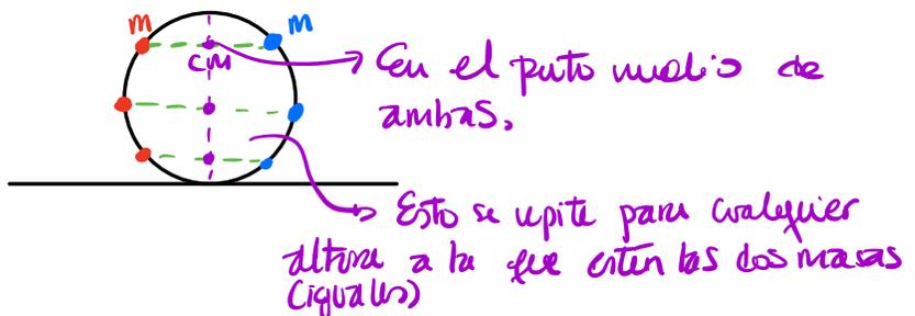
$\Rightarrow$  Es decir, necesitamos que la posición del centro de masa esté alineado con el eje de rotación.
