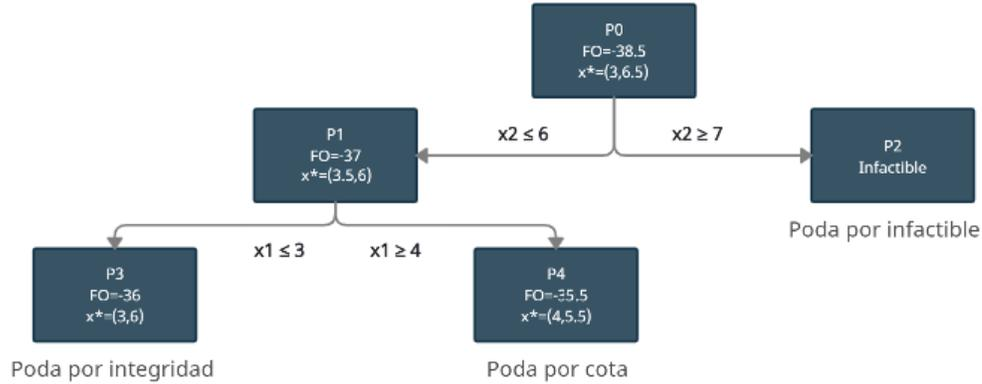
Figura 4: Arbol de enumeración de algoritmo de Branch & Bound.
