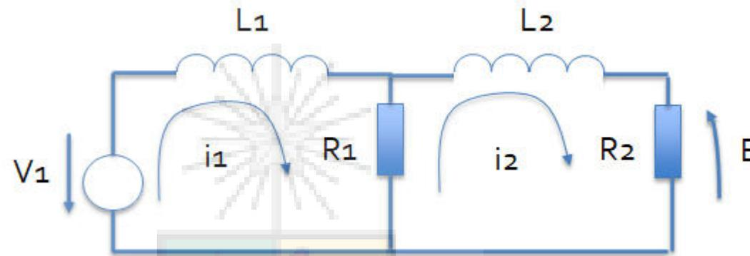
En el sistema mostrado en la figura anterior se requiere controlar E con cero error en estado estacionario a entrada escalón.
