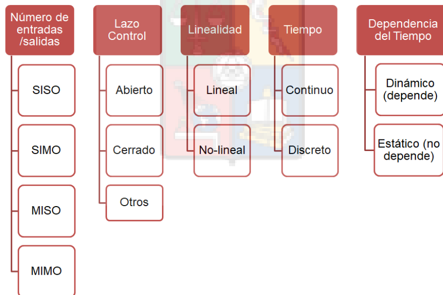
Figura 1.1: Clasificación de los Sistemas de Control. En este apunte se estudiarán los sistemas tipo SISO, lineales e invariantes en el tiempo (Figura tomada de las diapositivas de la Prof. Constanza Ahumada).
