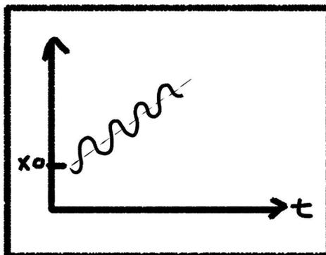
El movimiento consiste en un movimiento rectilíneo uniforme (MRU) + un movimiento armónico. Graficando la posición en función del tiempo, observamos una oscilación en torno a la recta definida por el MRU. Analizando casos límites para las constantes que definen el problema:
