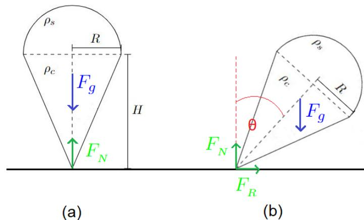
Figura 1: (a) Cono de helado vertical. (b) Cono de helado en una inclinación  $\theta$  arbitraria.
