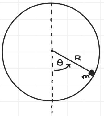
$m$  se lanza por dentro del cascarón, desde  $\theta_0$  con velocidad inicial  $\vec{v}_0 = v_0 \hat{\phi}$
