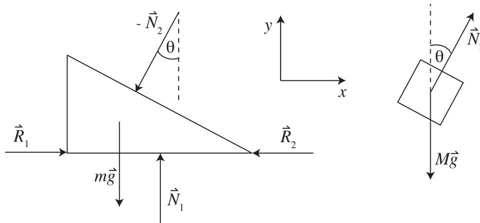
El bloque  $M$  cae por la cuña, por lo que tiene una aceleración que tiene componentes tanto en la dirección  $x$  como en la dirección  $y$ :  $\vec{a} = a_x \hat{x} + a_y \hat{y}$ , donde  $a_y < 0$  pues el bloque cae. Si vemos la segunda ley de Newton para  $M$  en la dirección  $y$ , se tiene que
