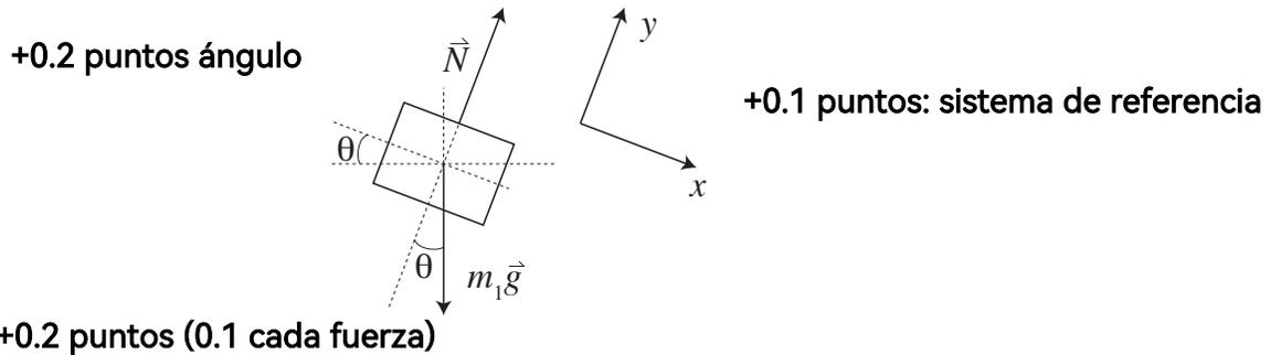
En el sistema de referencia  $(x, y)$  de la figura, la segunda ley de Newton indica que
