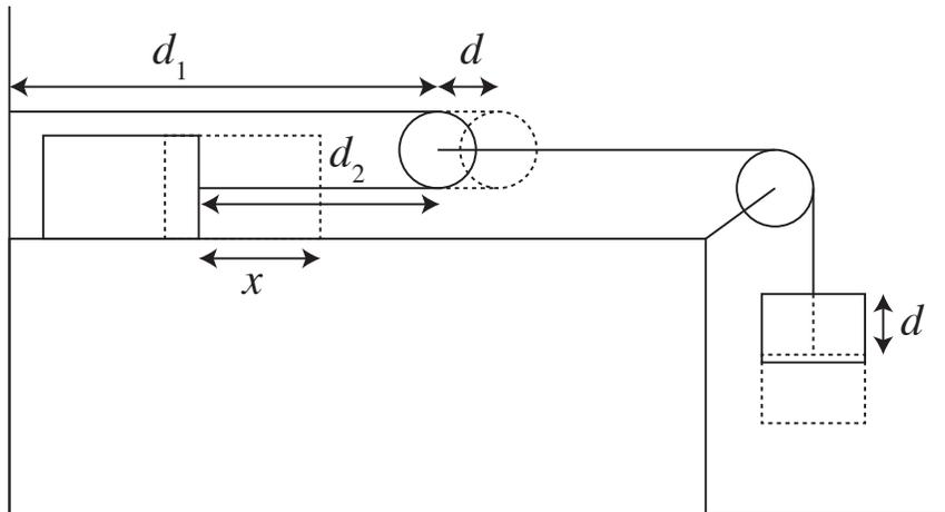
+0.5 puntos Por otro lado, la cuerda de la izquierda, también siendo inextensible, tiene una longitud constante. Comparando la longitud de la cuerda antes y después del movimiento, tenemos
