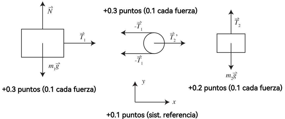
+0.1 puntos En la figura,  $|\vec{T}'_2| = |\vec{T}_2|$ . Usando el sistema de referencia  $(x, y)$  de la figura, tenemos por segunda ley de Newton, para  $m_1$ ,
