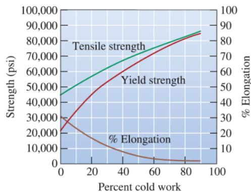
Se verifica que no se puede realizar el procedimiento con una etapa de trabajo en frío, el ancho de la placa se asume constante, por lo que %CW queda determinado por el espesor:
