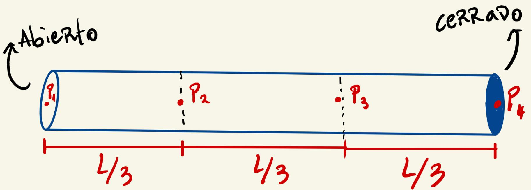
→ la longitud de onda para el segundo armónico de un tubo con una tapa cerrada y abierta es  $\lambda = 4L/3$ .
