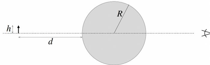
Tenemos un objeto de altura  $h$ , colocado a una distancia  $d$ , de una esfera de índice de refracción  $n$  y radio  $R$ .
