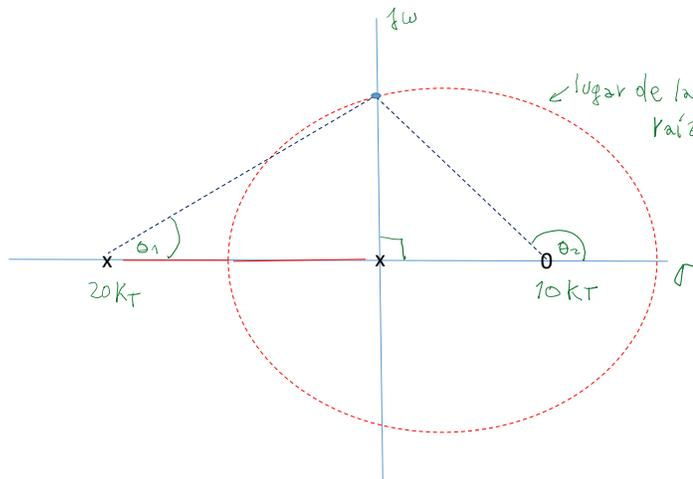
Para que el sistema sea estable, se debe operar con ganancia negativa (o sea la sumatoria de los ángulos debe dar igual a 0 grados, ya que la ganancia tiene los 180 grados incluidos). Asumiendo que el borde entre estabilidad e inestabilidad se produce al cruzar el eje imaginario en un punto  $x$ , se aplica la condición de ángulo cómo:
