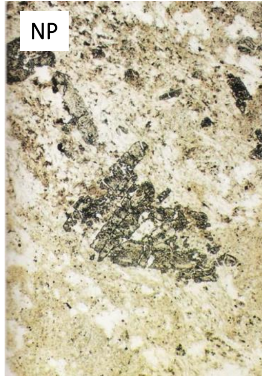
Lado mayor de la imagen = 2.5 mm (TS-PPL) Diásporo prismático en una zona rica en pirofilita.
