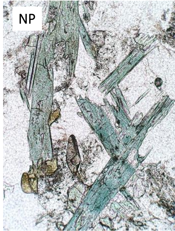
Lado mayor de la imagen = 1.2 mm. (TS-PPL) Act en un skarn (con cuarzo, epidota, microclina, titanita, granate).
