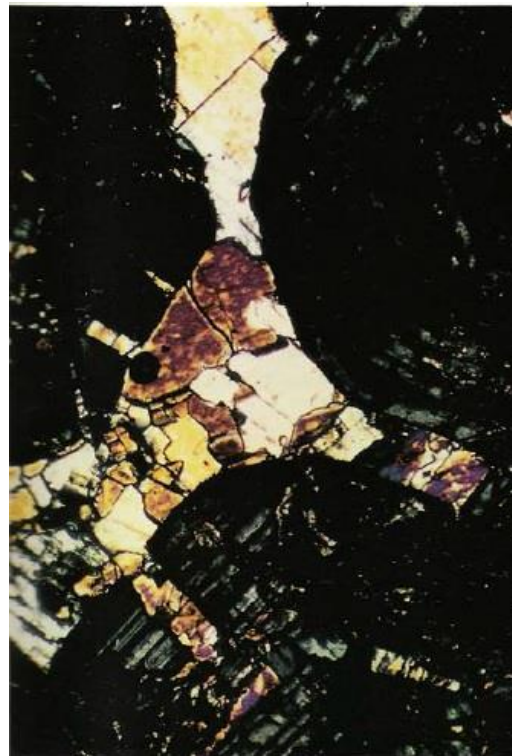
(TS-XPL) Anhidrita relleno de espacio entre granates. FOV = 1, 25 mm*
