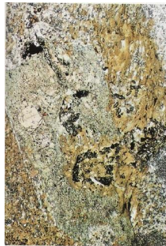
(TS) Bt reemplazando clpx en diorita. FOV = 1,3 mm*
