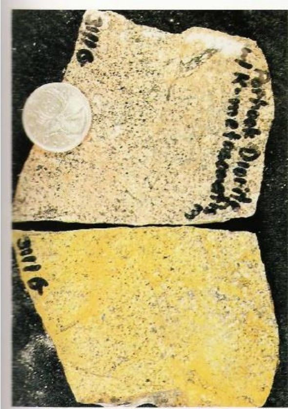
(HS) Diorita alterada por feld-K. (Arriba muestra sin teñir y abajo teñida) FOV = 13 cm*
