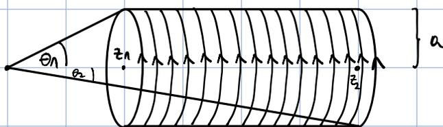
UNA BOBINA ES UNA COLECCIÓN DE ESPIRAS CIRCULARES. POR ESTO CALCULAMOS EL CAMPO GENERADO POR UN CIRCUITO CIRCULAR A UNA DISTANCIA  $z$ . LUEGO LA BOBINA SERÁ RESULTADO DE SUMAR SOBRE VARIOS CIRCUITOS.
