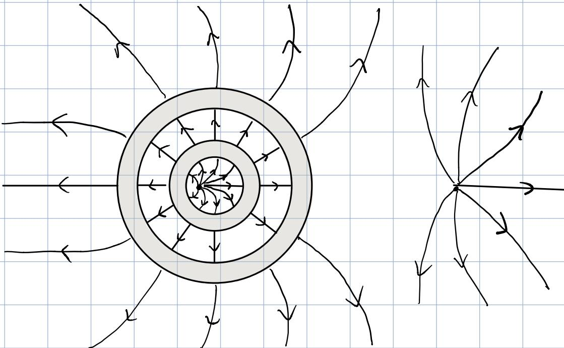
b) Como ahora ambos conductores estan conectados es como si fueran uno solo. Entonces, como un conductor es una superficie equipotencial, no puede haber campo entre la superficie interna del conductor 2 y la externa del conductor 1, pues eso produciría una diferencia de potencial entre estas 2 superficies, lo cual sería una contradicción. Para que no haya campo no debe acumularse carga en las superficies anteriormente mencionadas.
