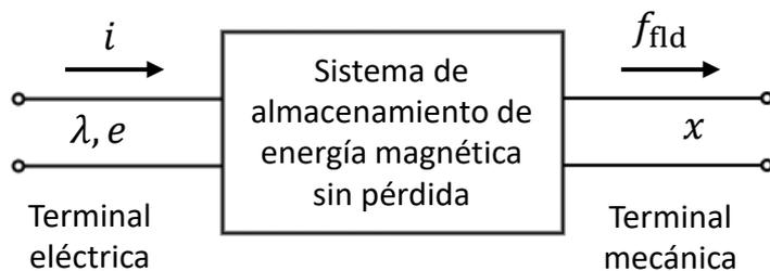
*Esquema de dispositivo de conversión electromecánica de campo magnético*
