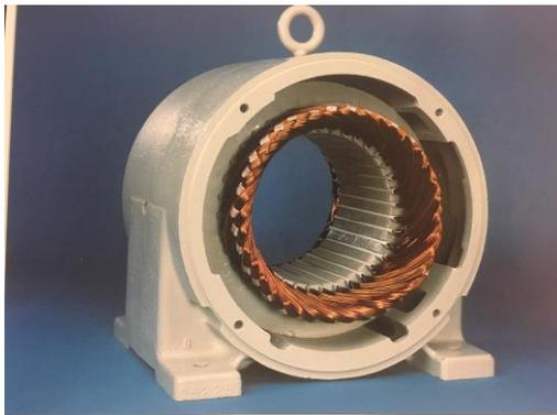
*Estator de una máquina de CA*
