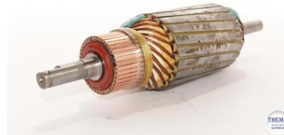
*Rotor de una máquina de CC*
