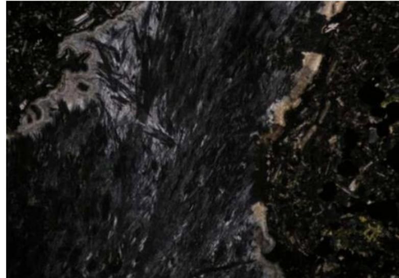
Bajos colores de interferencia, difícil identificación óptica del mineral específico (laumontita, heulandita, wairakita, etc)
