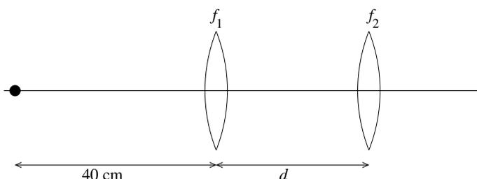
[P1B] Se tienen dos lentes delgadas convergentes de distancias focales  $f_1 = 20$  cm y  $f_2 = 10$  cm, y se sitúa un objeto a una distancia de 40 cm del primer lente, tal como muestra la figura. Calcule la distancia  $d$  entre las lentes si la imagen del objeto está ubicada a 35 cm de la primera lente y es una imagen virtual.
