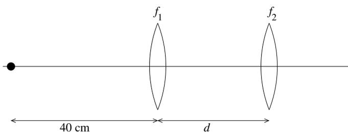
[P1C] Se tiene dos lentes delgadas, una convergente de distancia focal  $f_1 = 30$  cm y otra divergente de distancia focal  $f_2 = -40$  cm, como muestra la figura.
