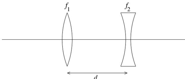
[P1D] Se tiene dos lentes delgadas, una convergente de distancia focal  $f_1 = 40$  cm y otra divergente de distancia focal  $f_2 = -30$  cm, como muestra la figura.
