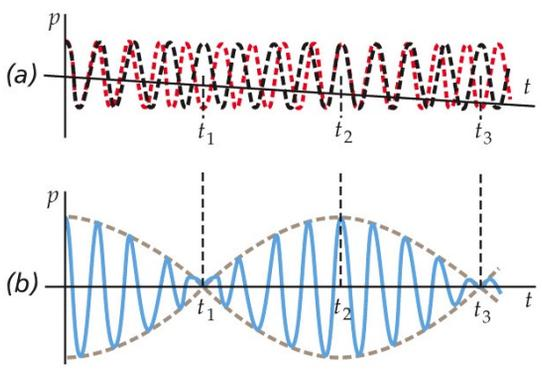
Podemos ver una onda "envolvente" (con  $f$  menor) y una onda con amplitud que oscila.
