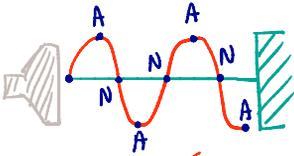
Si nos ponemos en nodos de presión, i.e., antinodo de desplazamiento no hay oscilación y entonces no se escuchara ningún sonido.
