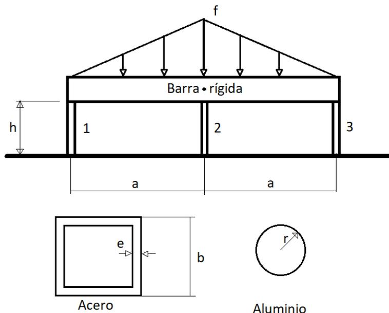
**P2.-** En la figura a continuación se tiene un sistema formado por dos sólidos de aluminio y acero que están perfectamente unidos (soldados) entre sí. En la figura se tiene una vista en corte del tubo de acero. La barra de aluminio está a una distancia  $\Delta = 0.1 \text{ cm}$  de la pared superior. Si al sistema se le aplica un cambio térmico  $\Delta T = 200 \text{ }^\circ\text{C}$ , determine la reacción ejercida por la pared superior sobre el sistema.
