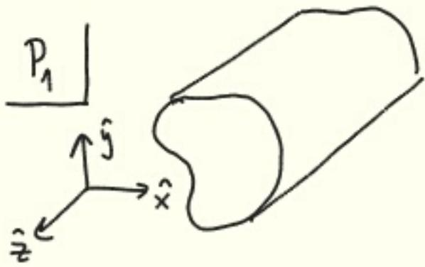
QUEREMOS DEMOSTRAR QUE NO EXISTEN MODOS TEM EN GUÍAS DE ONDA CON UNA ÚNICA SUPERFICIE CONDUCTORA ARBITRARIA. COMO LA ONDA SE PROPAGA EN  $z$  LOS CAMPOS SON DE LA FORMA:
