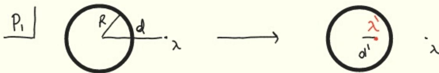
EN EL MÉTODO DE IMAGENES SE BUSCA PLANTEAR UNA DISTRIBUCIÓN DE CARGA QUE SATISFAGA LAS CONDICIONES DE BORDE DEL PROBLEMA. PARA ELLO SE ESCOGE UNA FORMA PARA LA DISTRIBUCIÓN (SUELE SER IDENTICA A LA ORIGINAL) Y SE DETERMINA LA POSICIÓN Y CARGA DE ESTA MEDIANTE LAS CONDICIONES DE BORDE.
