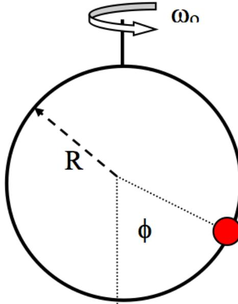
Figure 1: Una masa  $m$  está en un anillo de radio  $R$ . El anillo gira con velocidad angular constante  $\omega_0$ .
