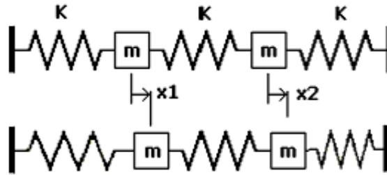
Figure 1: Dos masas  $m$  están atadas por un resorte de constante  $k$  entre ellas, además de que cada una está atada a una pared por medio de un resorte de constante elástica  $k$ .
