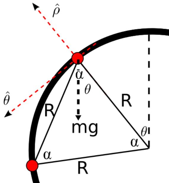
Figure 2: El sistema de referencia se pone convenientemente en la primera masa. En la imagen podemos ver la fuerza de la gravedad y la ubicación del ángulo  $\theta$  que se ha usado para proyectar.
