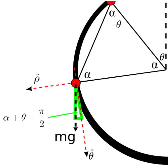
Figure 4: El sistema de referencia se pone convenientemente en la segunda masa. En la imagen podemos ver la fuerza de la gravedad y la ubicación del ángulo  $\alpha + \theta - \pi/2$  que se ha usado para proyectar.
