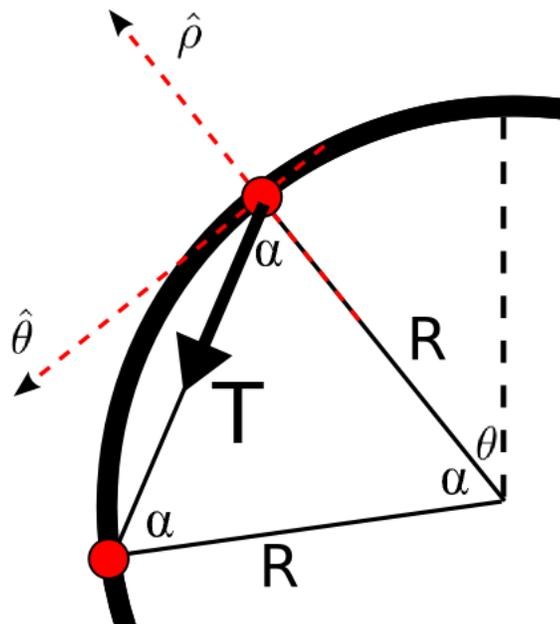
Figure 3: El sistema de referencia se pone convenientemente en la primera masa. En la imagen podemos ver la tensión y el ángulo  $\alpha$  usado para proyectar el vector.
