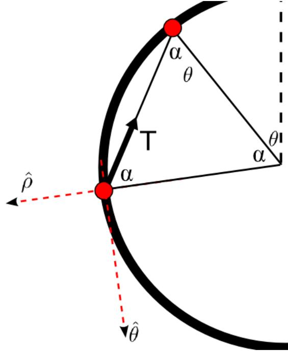
Figure 5: El sistema de referencia se pone convenientemente en la segunda masa. En la imagen podemos ver la tensión y que se usa el ángulo  $\alpha$  para proyectar.
