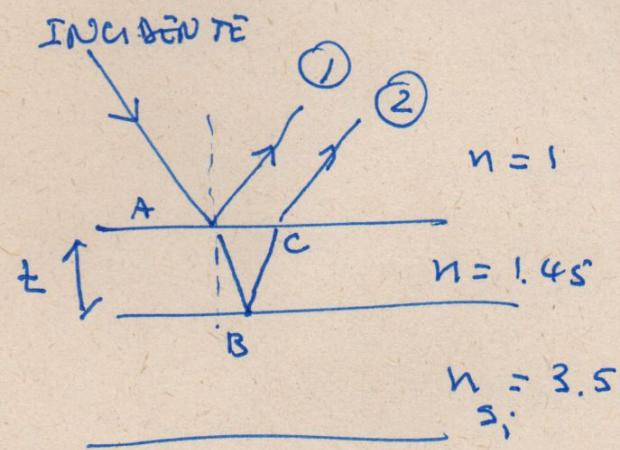
Los rayos ① y ② deben interferir destrutivamente ( $\Delta\phi = \pi, \pm \frac{3\pi}{2}, \pm \frac{5\pi}{2}, \dots$ )
