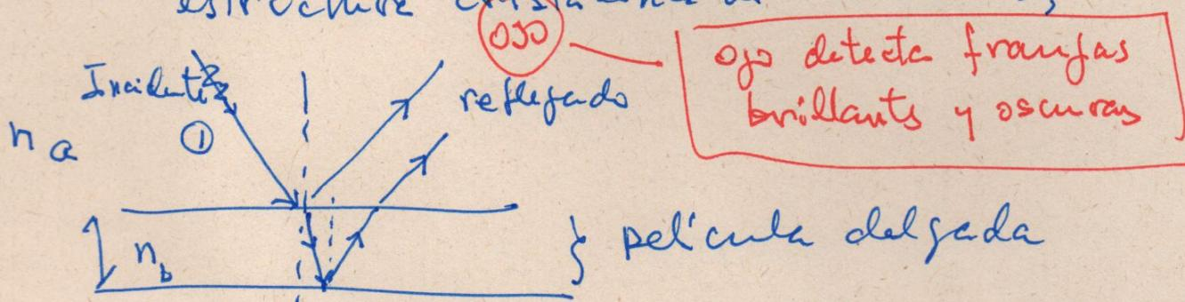
Existe interferencia (si la placa es delgada) entre el rayo reflejado en la superficie primera (cambio de  $n_a \rightarrow n_b$ ) y en la otra ~~extremo~~ superficie de la película delgada.
