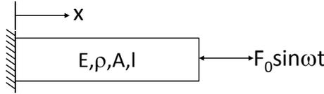
Figura 24.1: Barra empotrada con fuerza de excitación sinusoidal
