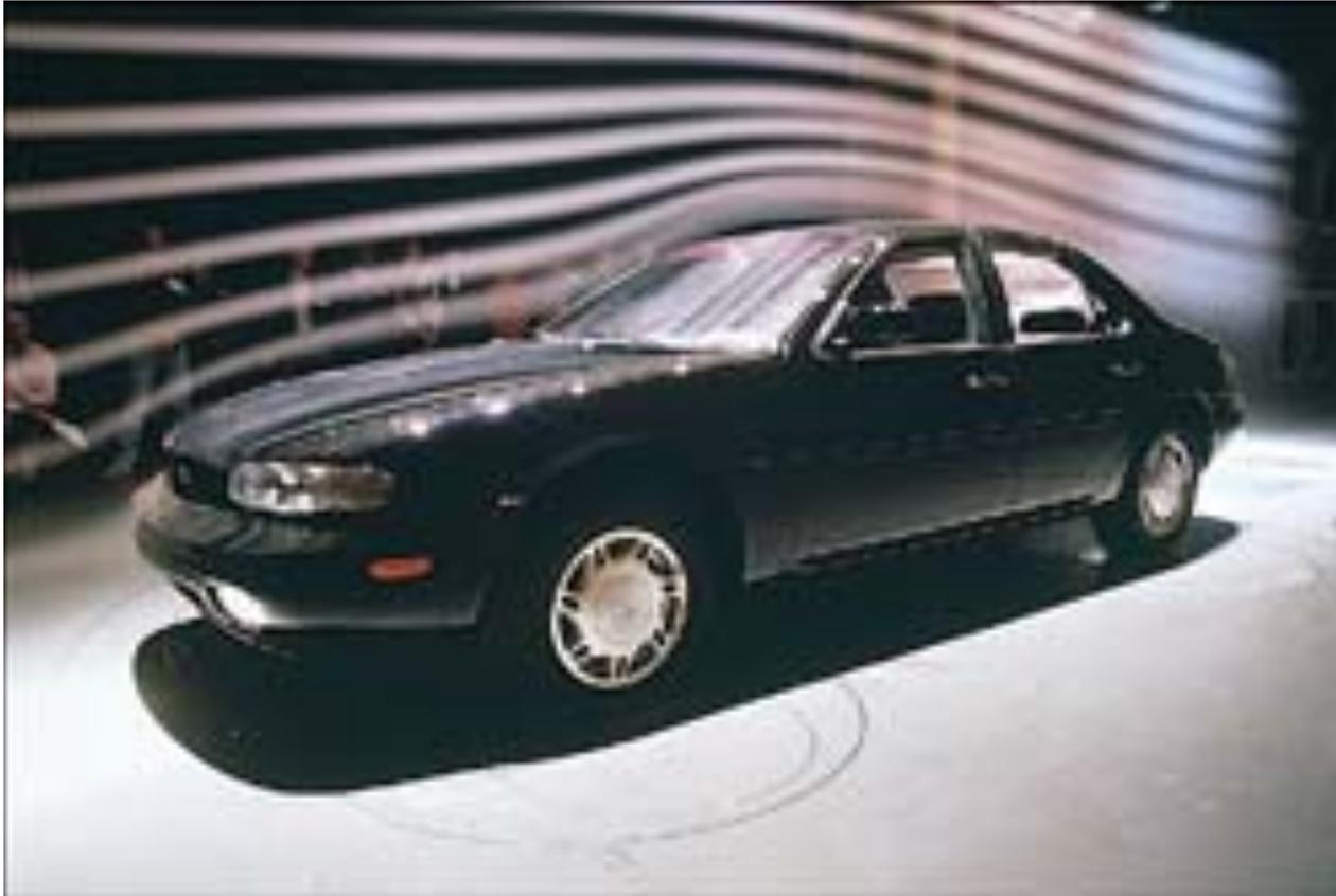
Flujo laminar alrededor de un automóvil en un túnel de viento
