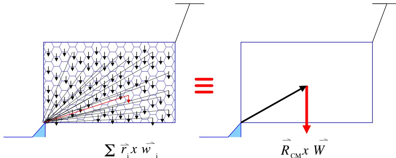
El torque del peso de un sólido es igual al torque ejercido por el peso del sólido concentrado completamente en su centro de masas.
