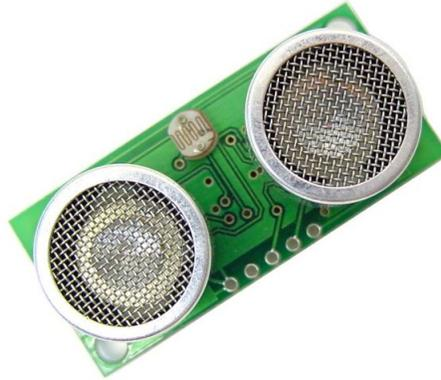
Figura 4: Sensor de ultrasonido.
