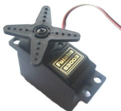
Figura 2: Servomotor común.
