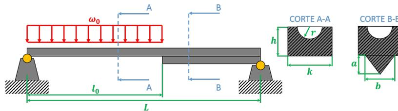
**Problema Deflexión.** La viga está sometida a un esfuerzo de distribución parabólica  $\omega_0(x) = 250(x - 5)^2 + 50$  [N/m].  $L=8$  [m];  $k=8$  [cm];  $k_0=1$  [cm];  $k_1=3$  [cm];  $h=5$  [cm];  $h_0=4$  [cm];  $h_1=2$  [cm];  $E=415$  [GPa]. Encuentre la deflexión de la viga.
