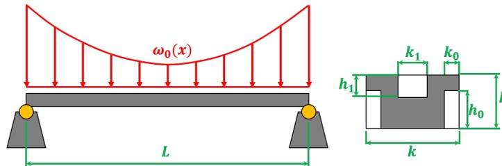
**Problema Corte.** Encuentre la distancia  $l_0$  que minimiza el esfuerzo de corte máximo en la viga y compárelo con el esfuerzo axial por flexión máximo.  $L=10$  [ft];  $l_2=4$  [ft];  $h=1$  [in];  $k_1=10$  [in];  $k_2=8$  [in];  $k_3=4$  [in];  $F=5500$  [lbf].
