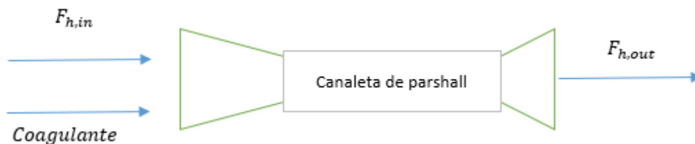
Figura 5: Diagrama de canaleta de Parshall
