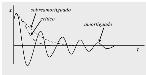
Fig. 6 : Oscilaciones amortiguadas, sobreamortiguadas y críticas
