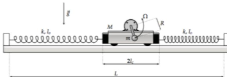
Figura 2: Diagrama del sistema resorte-carro-resorte
