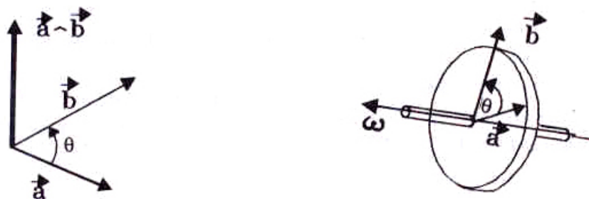
Figura XIII.1: Se indica la dirección y sentido del vector que representa el producto vectorial de los vectores \vec{a} y \vec{b} .
