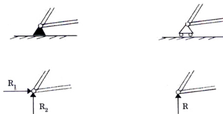
Figura XIII.10: Dos tipos de soporte de estructuras: uno fijo al piso y el otro con rodillos que permiten el deslizamiento. Se incluye el diagrama de cuerpo libre de cada uno de ellos.
