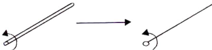
Figura XIV.3: Modelo usado para calcular el momento angular de una barra rígida. En rigor, este modelo identifica la barra con un segmento de una línea recta: no consideramos su ancho. Incluirlo complica el álgebra y no agrega nada conceptualmente nuevo.
