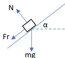
Figura 2: DCL en pista inclinada
