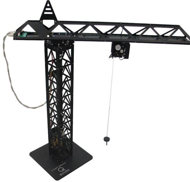
Figura 1: Grúa con tres grados de libertad
